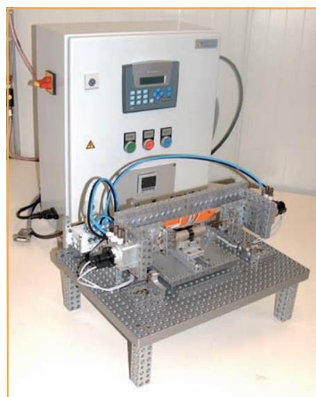
Afbeelding 3. Dynamische opstelling voor het duurtesten van een cilinderslot.
