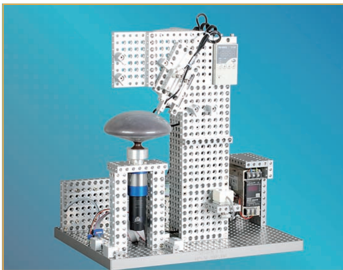
Afbeelding 6. Dynamisch-statische meetopstelling voor nauwkeurige wanddiktemeting van een medisch product.
